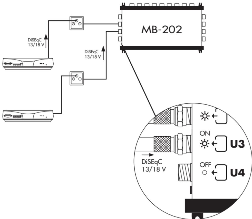
PREAMPLIFICACIÓN DE LA SEÑAL DE ANTENA
